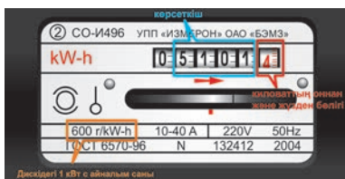
40-сурет. Механикалық есептегіштің электр энергиясын есептеу шәкілі Қара түспен кВт * сағ көрсетілген. Қызылмен – кВт * сағ үлесіндегі ағымдағы энергия шығыны, Қызғылт сарымен – 1 кВт айналым саны белгіленген
